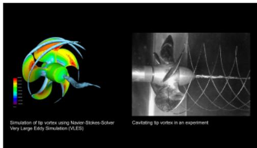
**Abbildung:** Numerische Simulation und reale Strömung
