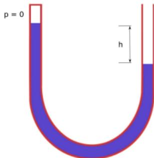
Die barometrische Höhenformel lässt sich aus der hydrostatischen Grundgleichung herleiten.
