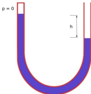
Mit Hilfe des hier gezeigten U-Rohr Barometers lässt sich der Atmosphärendruck bestimmen. Hier ist  $p_{at} = \rho gh$
