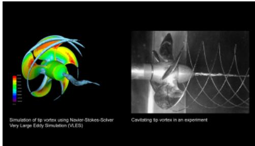
Abbildung: Numerische Simulation und reale Strömung
