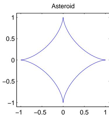
Lägg märke till att vi använder `axis equal` för att få rätt utseende (aspect ratio) och för att få lite ”luft” runt kurvan använder vi `axis([...])`. Vidare upphöjer vi med komponentvisa operationer (`t` är ju en vektor).
