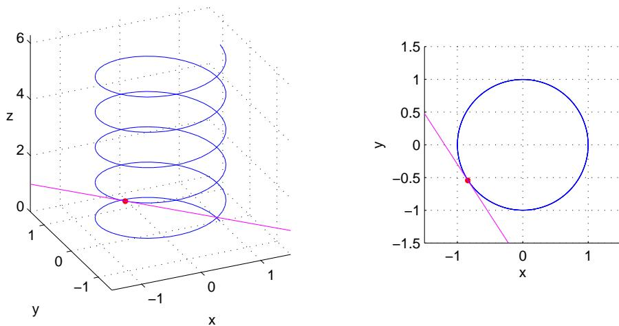
Vi använder `axis vis3d` så att skalan inte förändras då vi vrider och vänder på grafen, med `rotate3d on` blir det möjligt att ta tag i grafen och vrida den.
