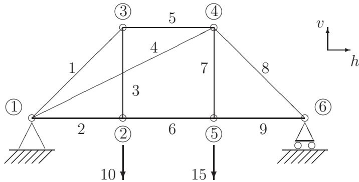
Genom att ansätta kraftjämviktsprincipen i horisontal- och vertikalled i knutpunkterna får vi ett linjärt ekvationssystem för de sökta krafterna i fackverkets grenar. Skriv upp det linjära ekvationssystemet och bestäm krafterna i de olika grenarna genom att lösa ekvationssystemet med MATLAB. Använd `sparse` och betrakta gleshetsstrukturen med `spy`.
