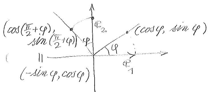
$$A = \begin{bmatrix} \cos \varphi & \sin \varphi \\ -\sin \varphi & \cos \varphi \end{bmatrix}$$
