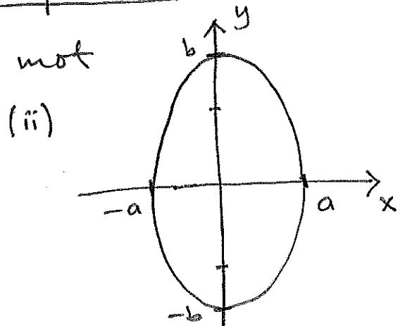
Brännpunkterna är intressanta då ellisen utgörs av de punkter vars sammanlagda avstånd till brännpunkterna är konstant.
